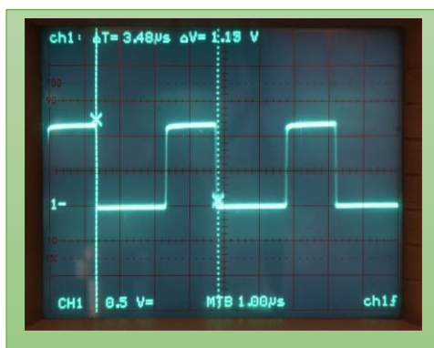
Figure 4 : oscillogramme du signal en sortie de l'oscillateur PO – Fréquence mini.
