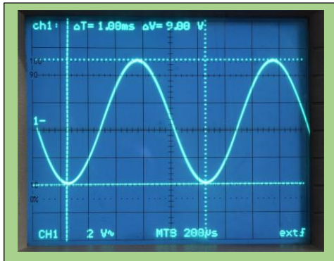
Figure 18 : oscillogramme du signal AF à la sortie du circuit TL071 (PT-7) et à la sortie du modulateur (PT-8).
