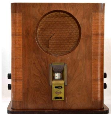
Figures IV.22 & IV.23 : ce récepteur Sachsenwerk modèle Eswe 3 W (1930) ne possède pas de cadre : le signal RF en sortie du MiniTx PO-GO est alors véhiculé via le câble blindé situé en sortie du cadre d'émission.
