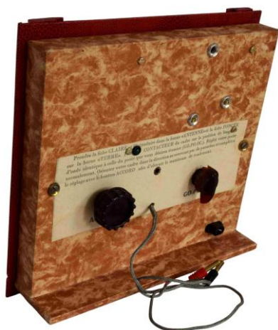
Figure IV.26 : le cadre transformé en émetteur PO-GO de proximité grâce au module MiniTx PO-GO .
