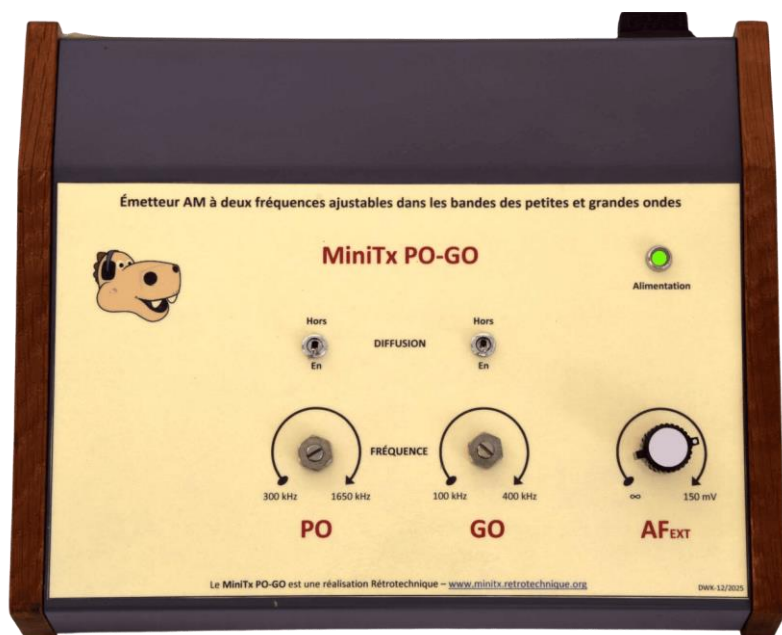
Figure III.12 : le coffret type pupitre, câblé, testé, en fonctionnement.
