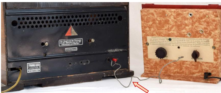
Figures IV.22 & IV.23 : ce récepteur Sachsenwerk modèle Eswe 3 W (1930) ne possède pas de cadre : le signal RF en sortie du MiniTx PO-GO est alors véhiculé via le câble blindé situé en sortie du cadre d'émission.
