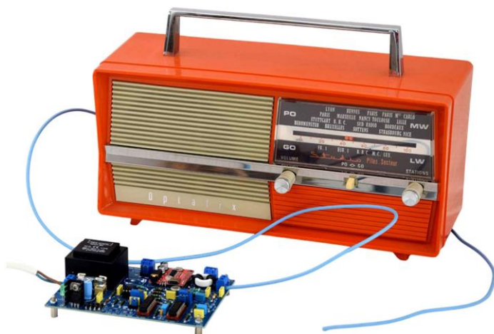
Figure III-09 : rayonnement hertzien de la sortie RF du MiniTx PO-GO via une antenne filaire raccordée sur le bornier J2 du module.
