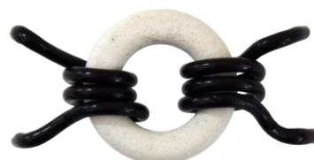
Figure II-07 : transformateur RF L3.
