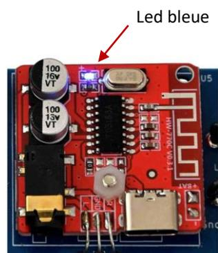
Figure IV-01 : repérage led bleue du module Bluetooth.
