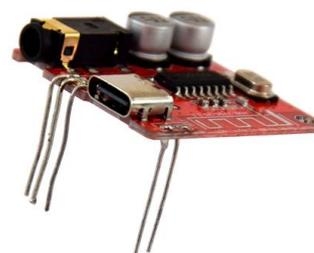
Figure II-08 : module Bluetooth, une fois préparé.
