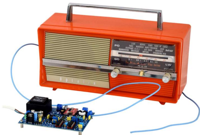
Figure III-10 : rayonnement hertzien de la sortie RF du MiniTx PO-GO via une antenne filaire raccordée sur le bornier J2 du module.
