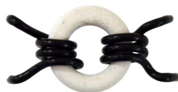
Figure II-07 : transformateur RF L3.
